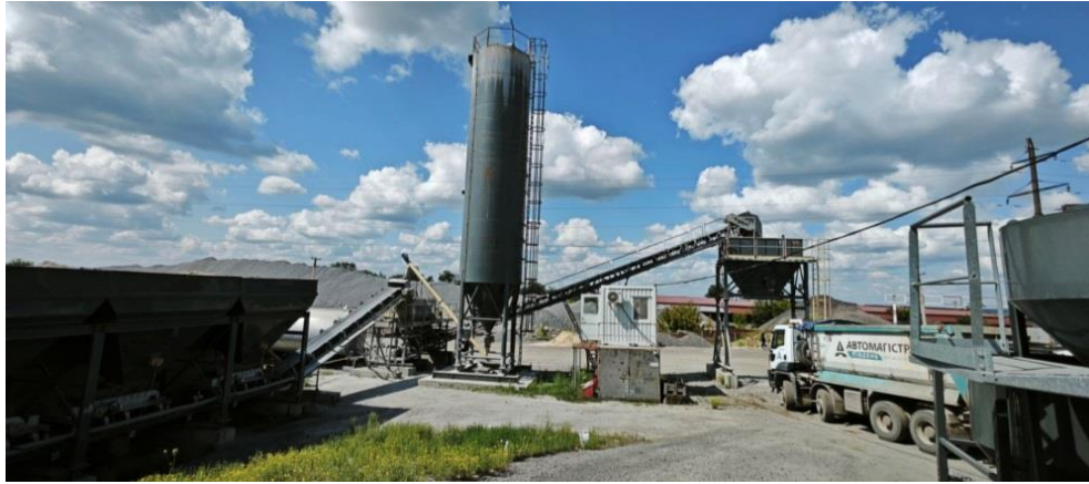
Рисунок 1 — Установка MARINI coldFALT600
