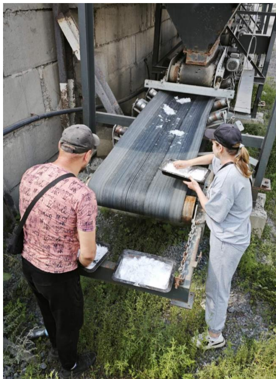
Рисунок 2 — Введення фіброволокон до складу суміші
